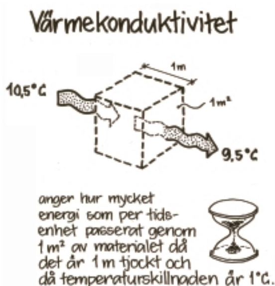
Figur 2. Illustration av värmekonduktivitet. (Källa: Teknisk isolering, Isoleringfirmornas Förening)
