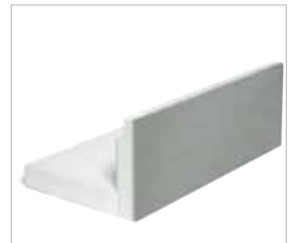
PAROC XGL 100, L-element Element med färdig sockleyta för kantisolering av platta på mark. Anpassad för golvvärme. Monteras utan form.
