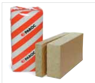
PAROC UNS 37zpf, Snedtaksskiva Isolering mellan takstolar i snedtak samt i stödbensväggar. Monteras inifrån. Pappersbeklädd på en sida.
