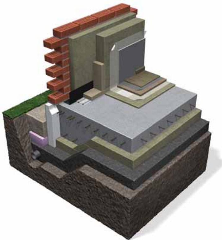
Figur 1. Kombination av isolering under och ovanpå plattan.
